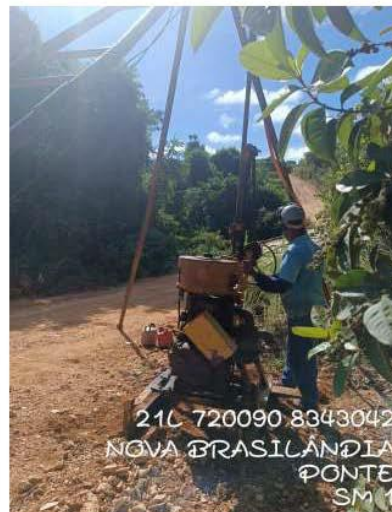
Foto 02 - Vista da execução da sondagem.
